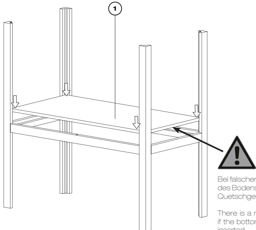
Bei falschem Einlegen des Bodens besteht Quetschgefahr.
